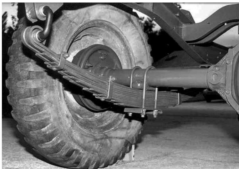
FIG. VII.10: Amortisseur à lames constitué par la superposition de plusieurs lames travaillant en flexion (référence : <http://fr.wikipedia.org/wiki/Image:Leafs1.jpg>)
